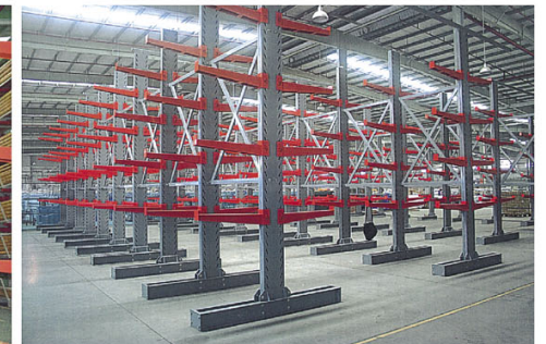
广州阿波罗公司悬臂式货架应用实景拍摄(1000KG/支臂) Cantilever system in Guangzhou Apollo
